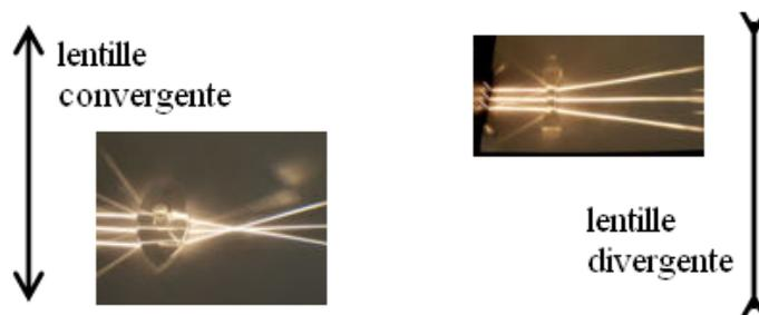
FIG. 5.13 – Symbole en double flèche utilisé dans le cas des lentilles minces.
